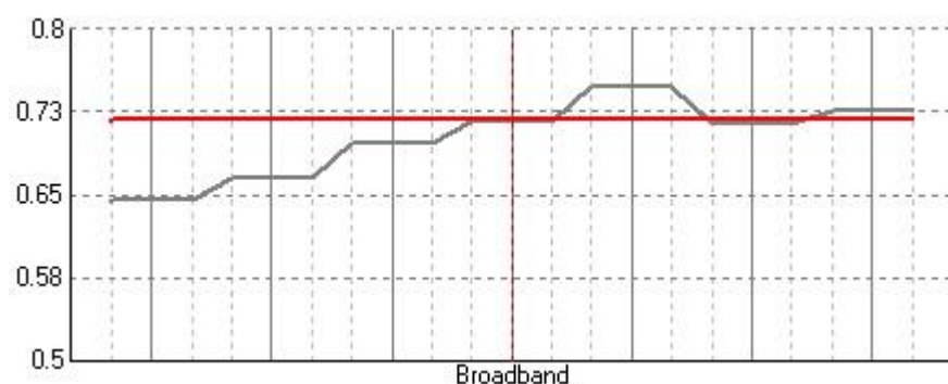
Rys.4. Wskaźnik transmisji mowy STI uzyskany w programie EASE 4.3
